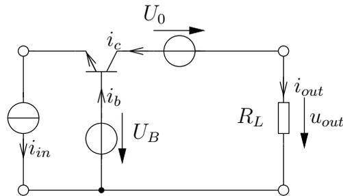
Die Bauelement-Werte seien so gewählt, dass sich der Transistor im Vorwärtsbetrieb befindet. Im Vorwärtsbetrieb gilt:
