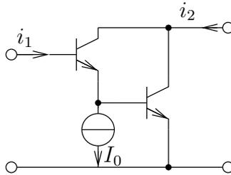
Beide Transistoren befinden sich im Vorwärtsbetrieb. Ferner gelte für beide Transistoren  $i_c = \beta i_b$ .
